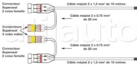
Faisceau principal en 2 parties (1 droit + 1 gauche), composée chacune de 10 mètres de câble méplat 2 x 1,5 mm<sup>2</sup> avec connexion d'origine AMP 2 voies Superseal.&#8200;
