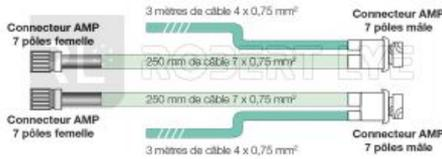
Faisceau pour véhicule équipé de feux Vignal LC5 ou LC8
